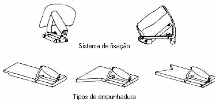
Figura 30 – Diferentes tipos de dispositivos empurradores Fonte: Espanha – Instituto Nacional de Seguridad e Higiene en el Trabajo (1983)
