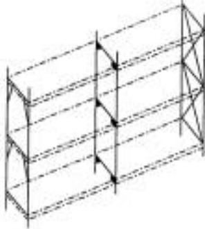
a) Arriostramientos transversales
